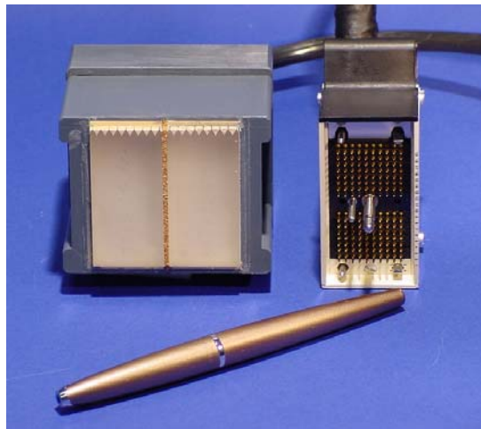
Type de capteur : TS45 1 6C1, 2x(2x11) éléments, Angle 30 à 85°, Empreinte 54x54 mm, 1MHz Figure 20
