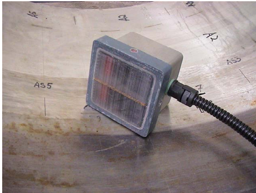
Type de capteur : TS55 1.5. 6C1, 2x(2x16) éléments, Angle 30 à 90°, foot print 54x54 mm Rodage de sabot : convexe
